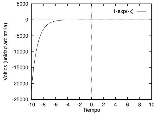
Figura 24.2: Carga de un condensador.
