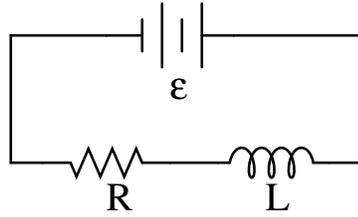
Figura 20.1: Circuito con una resistencia y una autoinducción.
