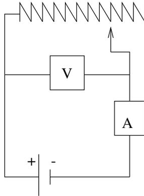
Figura 32.1: Circuito para comprobar la ley de Ohm.
