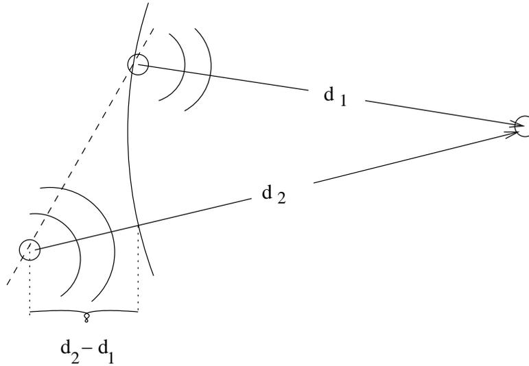
Figura 18.1: Esquema de un fenómeno de interferencias.
